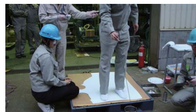
静電気による着火実験
