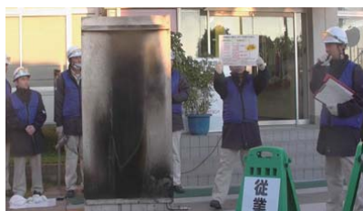
静電気による着火実験
